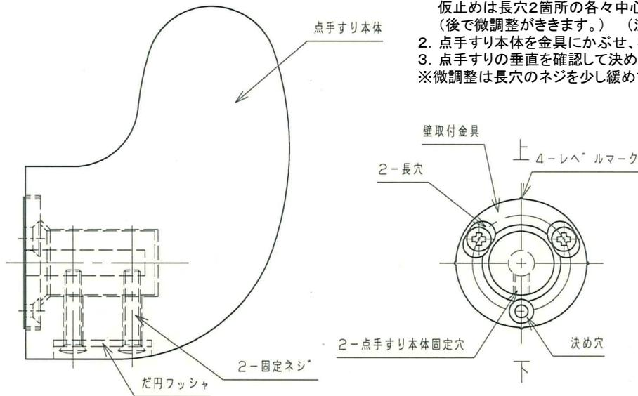
1. 取付位置を決めて壁取付金具を点手すり固定穴を真下に仮止めします。
